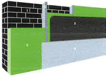
1. Buitenmuur | 2. Isolatie | 3. Vochtschermb | 4. Afwerkingslaag | 5. Stijl- en regelwerk (optioneel)
